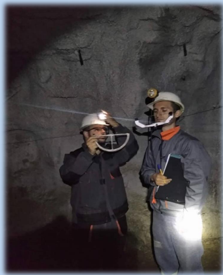
Извършване на компасна снимка в рудник Ерма река
