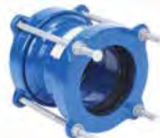
Универсален адаптор за стоманени,циментови & PVC тръби Ултралинк PN16 PAM отклонение ±6° Universal adaptor for steel, cement PVC & PE pipes Ultralink PN16 PAM angular deflection ±6°
